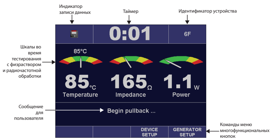
Рисунок 12. Начата радиочастотная обработка (устройства ClosurePlus, ClosureRFS и ClosurePlex)
