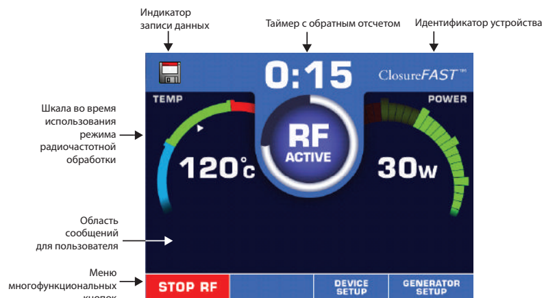
Рисунок 11. Начата радиочастотная обработка с помощью устройства ClosureFAST
